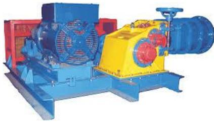
Gambar 6 Turbin *Crossflow*
