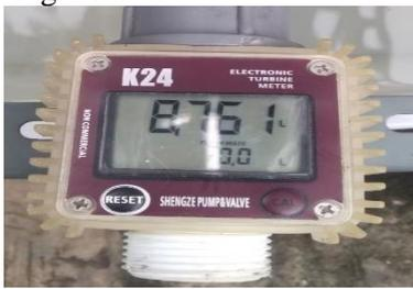
Gambar 11 Hasil Uji Coba Laju Aliran Air Pada Pipa Pen Stock 3
