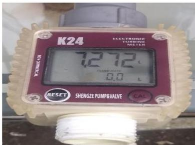
Gambar 12 Hasil Uji Coba Laju Aliran Air Pada Pipa Pen Stock 4
