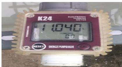
Gambar 3.4 Hasil Uji Coba Aliran Pada Output Keseluruhan Pompa
